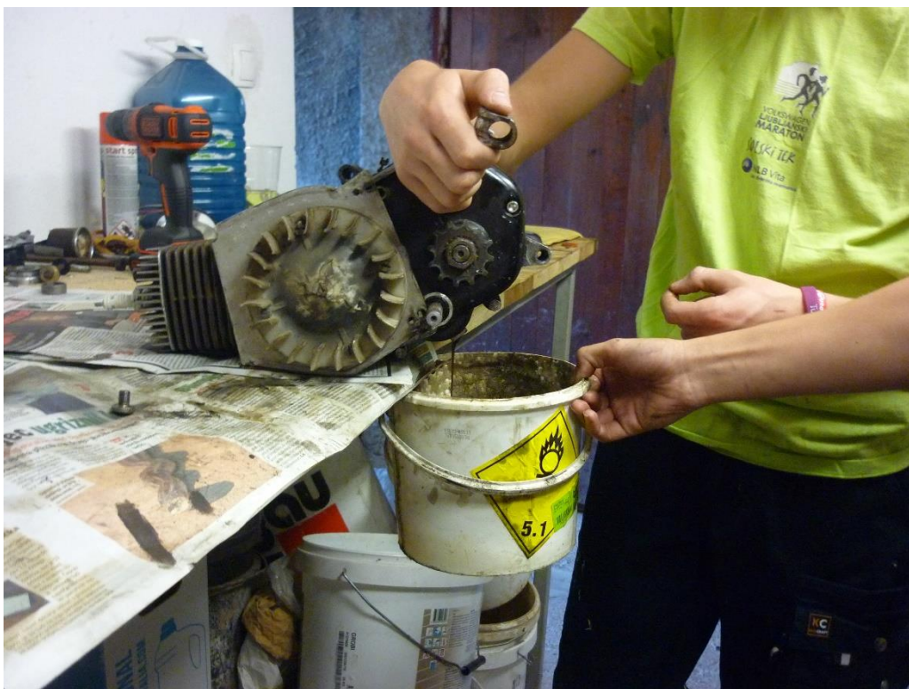
Slika 15: Odstranjevanje motornega olja iz agregata
