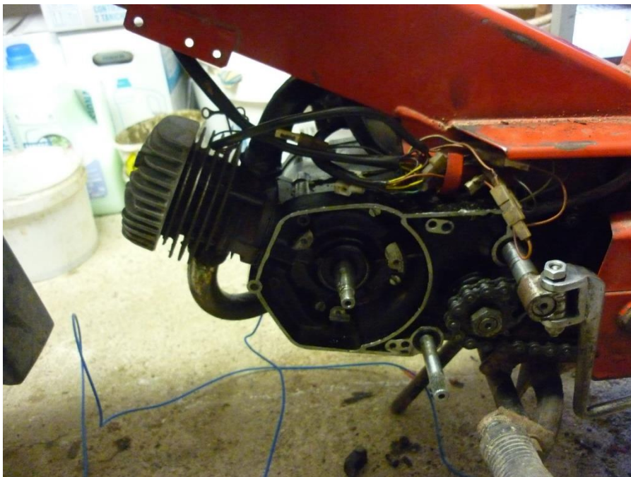
Slika 28: Nameščanje agregata na motor
