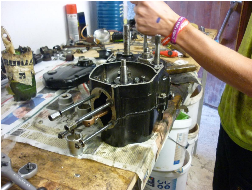
Slika 25: Privijanje vijakov bloka motorja.
