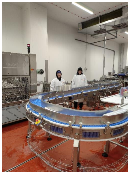
Slika 13: Avtomatska linija za sveže meso in mesne pripravke pakirane v kontrolirani atmosferi
